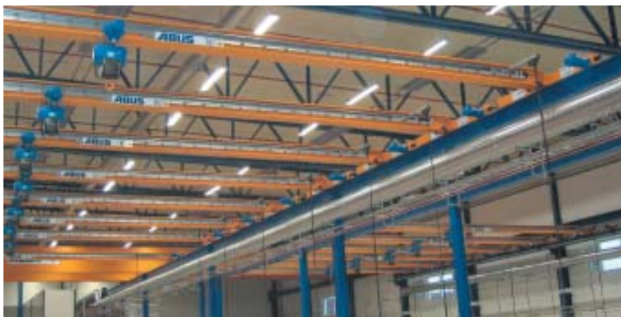
Inflyttningsklart! 36 nya radiostyrda ABUS-traverser är redo att betjäna ABS Pump i Vadstena.
